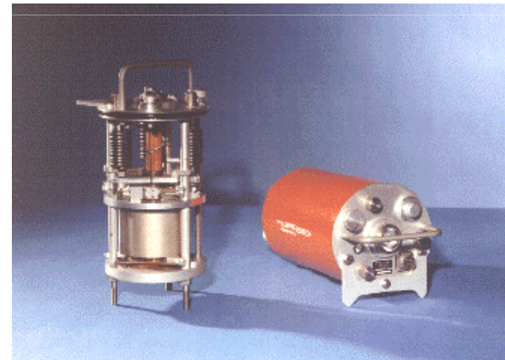
Slika 185. Elektromagnetski seizmometar: a) šema vertikalnog seizmometra: (1)-kućište; (2)-čelična opruga; (3)-trajni magnet; (4)-radni kalem; (5)-prigušni (i kalibracioni) kalem; (6)-kabl za odvođenje indukovano napona na pojačavač i registrator signala; b) Realni izgled seizmometra tipa S-13 Teledajn-Džiotek (Teledine-Geotech) u vertikalnom (raskolpljenom) i horizontalnom položaju.
